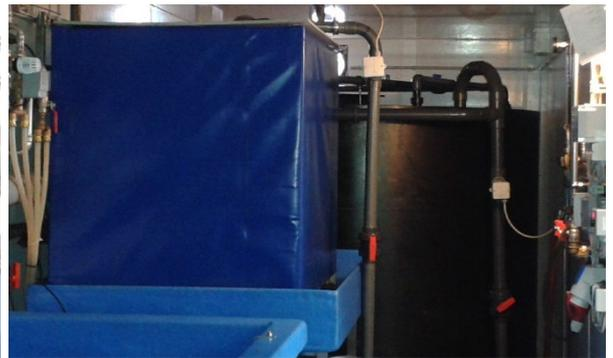
Abbildung 4: Entgasungsturm (rechts) und MovingBed- Biofilter (links)
